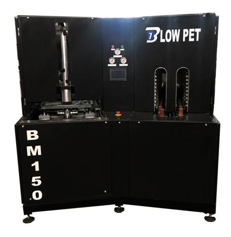
دستگاه و BLOWPET BM150 با توجه به مرغوبیت بالای اجزاء متشــــکله در ساخت دستگاه، طول عمر و ظریب اطمینان بالا و همچنین ســـادگی خاص در طراحی و تعمیر و نگهداری، امروزه یکی از برترین نوع دســـتگاه های بادکن نیمه اتوماتیک به شــــمار می رود. دســـــــتگاه نیمه اتوماتیک بوده و قابلیت تولید بطری ۱۶ و ۲۰ لیتری دســــــته دار تک کویت، ۵ و ۱۰ لیتری دو کویت با ظرفیت تولید ۱۰۰ تا ۲۰۰ عدد بطری در ساعت را دارد.
